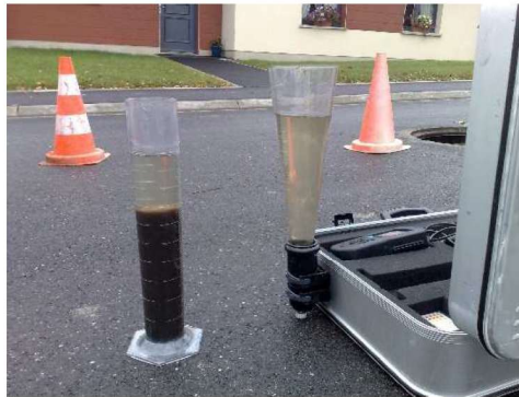
Mesure du volume de boues activées dans le SBR (à gauche) Mesure des matières décantables de la bouteille d'échantillonnage avec cône Imhof (à droite)
