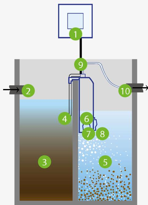
Le schéma représente un AQUAMAX<sup>®</sup> BASIC disposé sur la cloison séparant le décanteur du réacteur biologique d'une cuve Béton.
